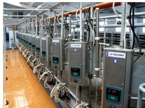
Установки доильные предназначены для машинного доения коров на специальной площадке в станках, расположенных попарно под углом 30° относительно технологической ямы. Предусмотрено одновременное открытие передних ограждений посредством механического привода, что обеспечивает быстрый выход животных из доильных станков.
