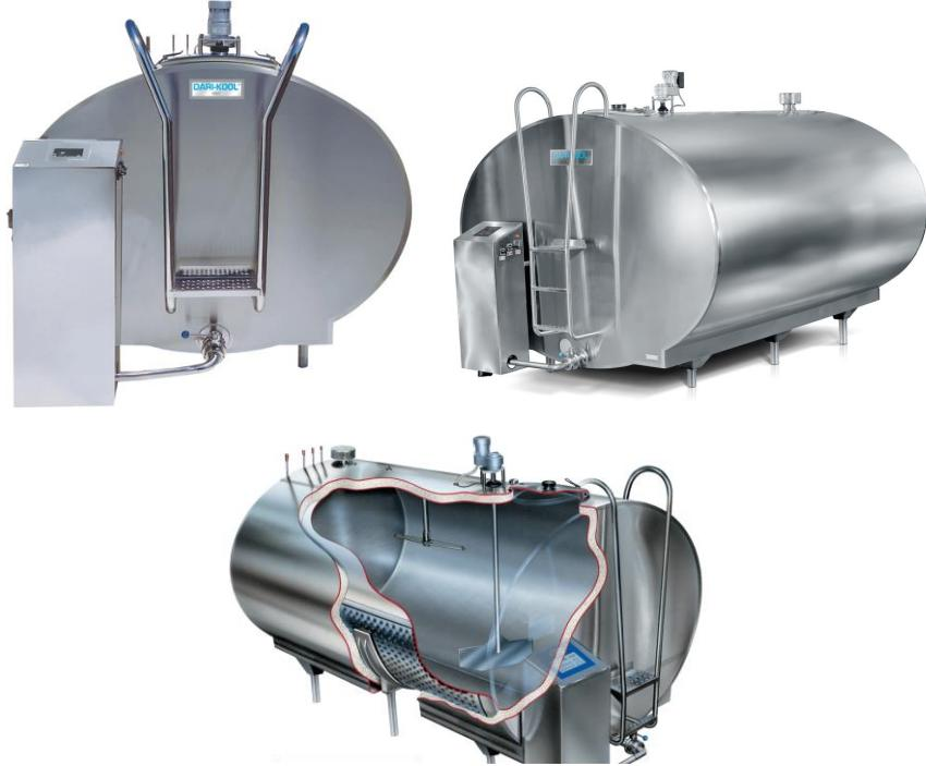
Молокоохладитель представляет собой емкость из пищевой нержавеющей стали, внутри которой находится испаритель. Охлаждение молока после дойки до температуры ниже +4°C, его хранение при этой температуре а также автоматическую промывку молочной емкости после выгрузки молока.
