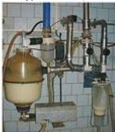
**Установка доильная ПДУ-8/ ПДУ-8М** (доение в ведро или молокопровод на пастбище или в лагере с приводом вакуумной станции от ВОМ трактора, от электродвигателя или от небольшого двигателя внутреннего сгорания);
