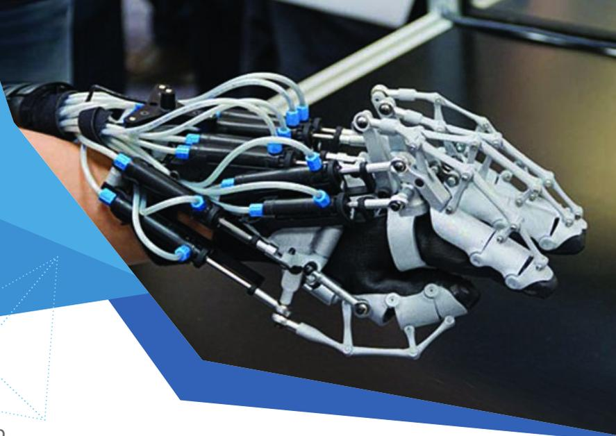
Экзоскелет – техническое устройство или набор компонентов, позволяющее усилить (усовершенствовать) способности человека при выполнении различных задач в передвижении, перемещении грузов и иные способности. Экзоскелет повторяет биомеханику человека для пропорционального увеличения усилий при движениях.
